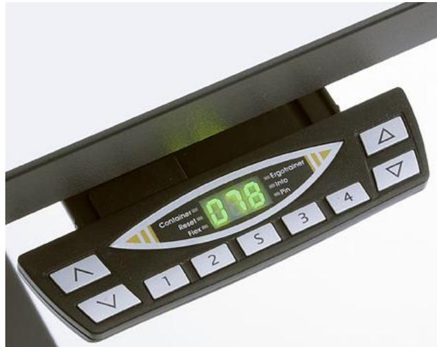
Initialisierung). Sie leuchtet bis die Initialisierung abgeschlossen ist. Die Info-LED zeigt an, dass die Steuerung einen Fehler erkannt hat. Gleichzeitig wird im Display anstatt der aktuellen Tischhöhe ein Fehlercode „Exx“ angezeigt. Die LED's „Container, Flex, Ergotrainer u. Pin“ werden nicht verwendet. Die Tasten „Auf“ und „Ab“ sind links und rechts identisch belegt.
